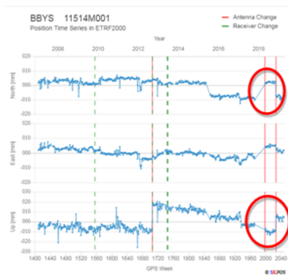
Obr 3. Ukážka skokov v súradniciach časových radov spôsobených výmenou antény referenčnej stanice.
